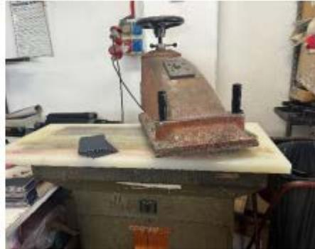
*Dalla fustellatrice a bandiera è stato rimosso il dispositivo di arresto di emergenza, necessario all'arresto immediato della macchina in caso di necessità sopraggiunte*
