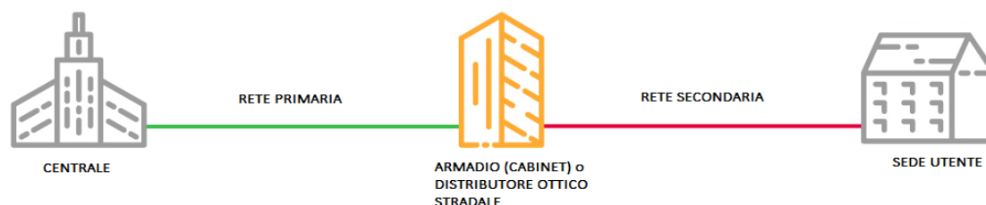
Figura 1 – Schema esemplificativo degli elementi di rete che costituiscono la rete locale di accesso all'ingrosso.
