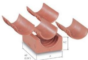
87. Il modulo HandiBlock è formato da due semi-gusci, al cui interno vi è una c.d. "Insertstrip" dotata di anelli di compressione rimovibili, ciascuno dei quali riporta i diametri dei cavi/tubi da inserire. Togliendo gli anelli di compressione dall'Insertstrip, in funzione del diametro del cavo da inserire, si ottiene l'adattamento del modulo al cavo, con l'applicazione di un lubrificante.
